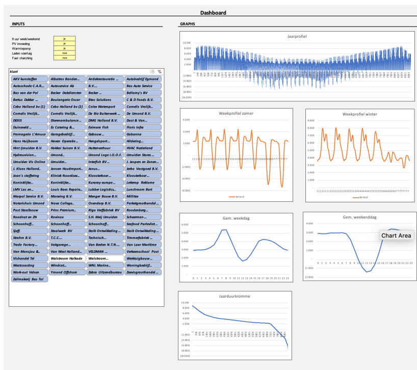
Figuur 5: Toekomstige gezamenlijk energieprofiel van de ondernemers in IJmuiden Haven. Hierbij het afname profiel, in combinatie met gemodelleerde zon-PV invoeding en inzet van warmtepompen (zonder walstroomverbindingen).
